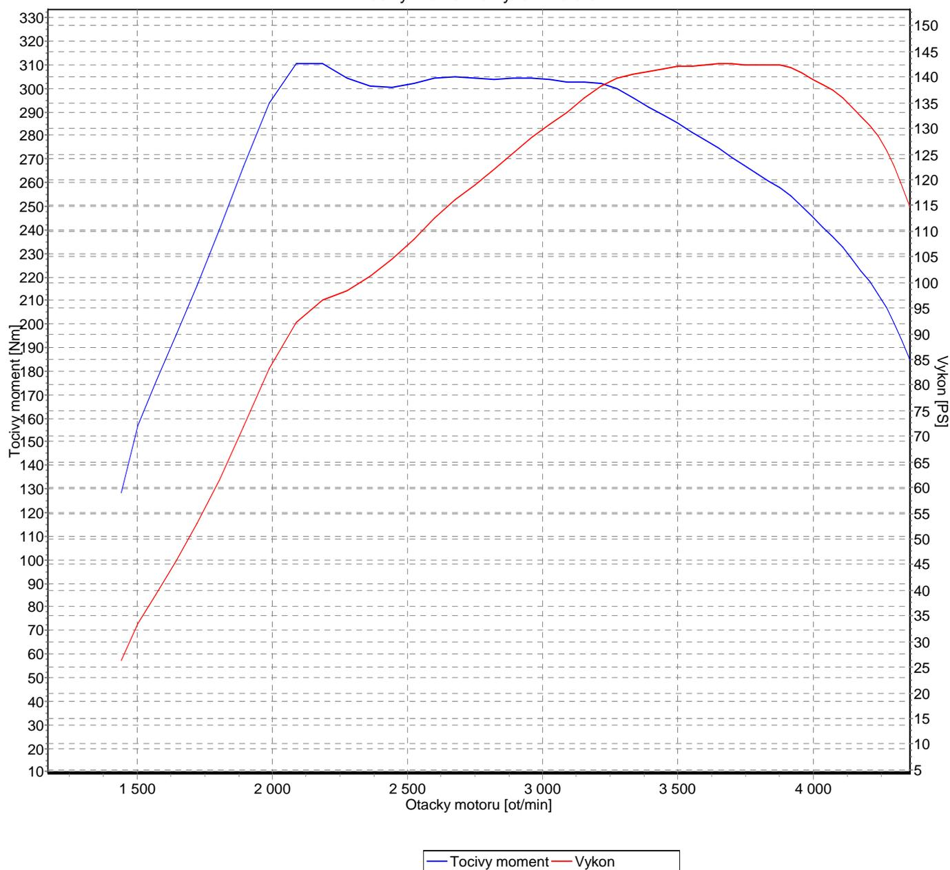
Maximalni tocivy moment 310,56 Nm pri 2087 ot/min, Maximalni vykon 142,69 PS pri 3650 ot/min, Vykon navysen o 1,1% podle ISO
