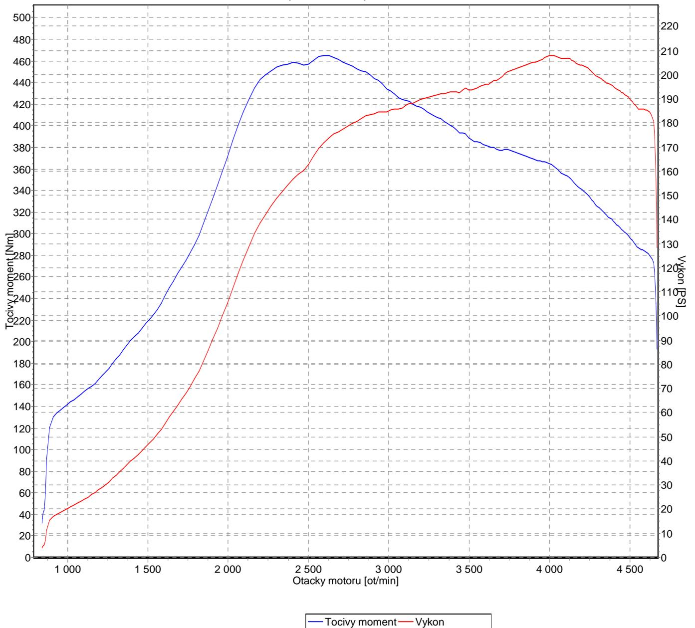
Maximalni tocivy moment 465,38 Nm pri 2595 ot/min, Maximalni vykon 208,07 PS pri 4014 ot/min, Vykon navysen o 1,2% podle ISO
