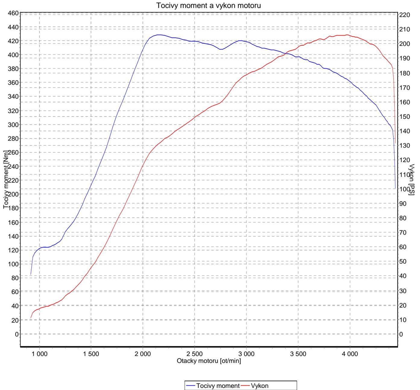
Maximalni tocivy moment 427,9 Nm pri 2175 ot/min, Maximalni výkon 206,04 PS pri 3966 ot/min, Výkon navysen o 3,3% podle ISO
